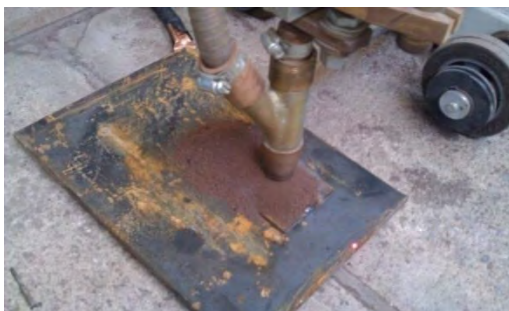
۴-جوشکاری نمونه روی صفحه فلزی به منظور اجتناب از وزش قوس
