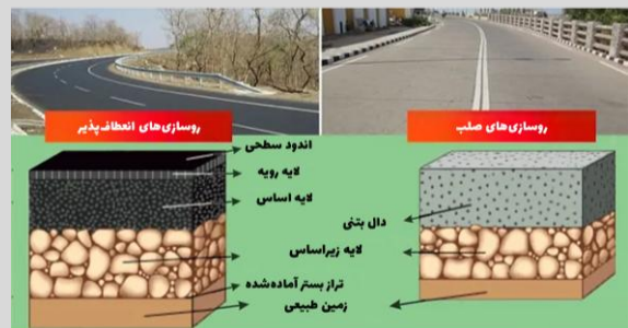
(شکل ۳-۲) تفاوت لایه‌های زیرین روسازی صلب و انعطاف‌پذیر
