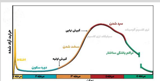
(شکل ۲-۴) نمودار رفتار حرارتی سیمان در بتن ریزی
