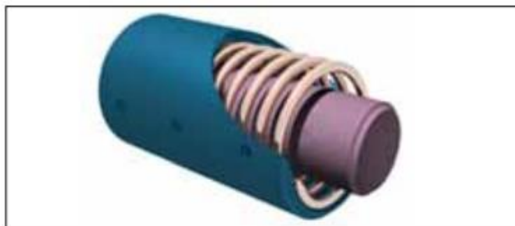
شکل ۹: ساختار یک مبدل مگنتواستریکتیو ساده
