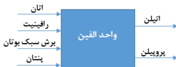
شکل (۱۰-۴) فرآیند تولید اتیلن و پروپیلن در یک مجتمع الفین [۴۱]
