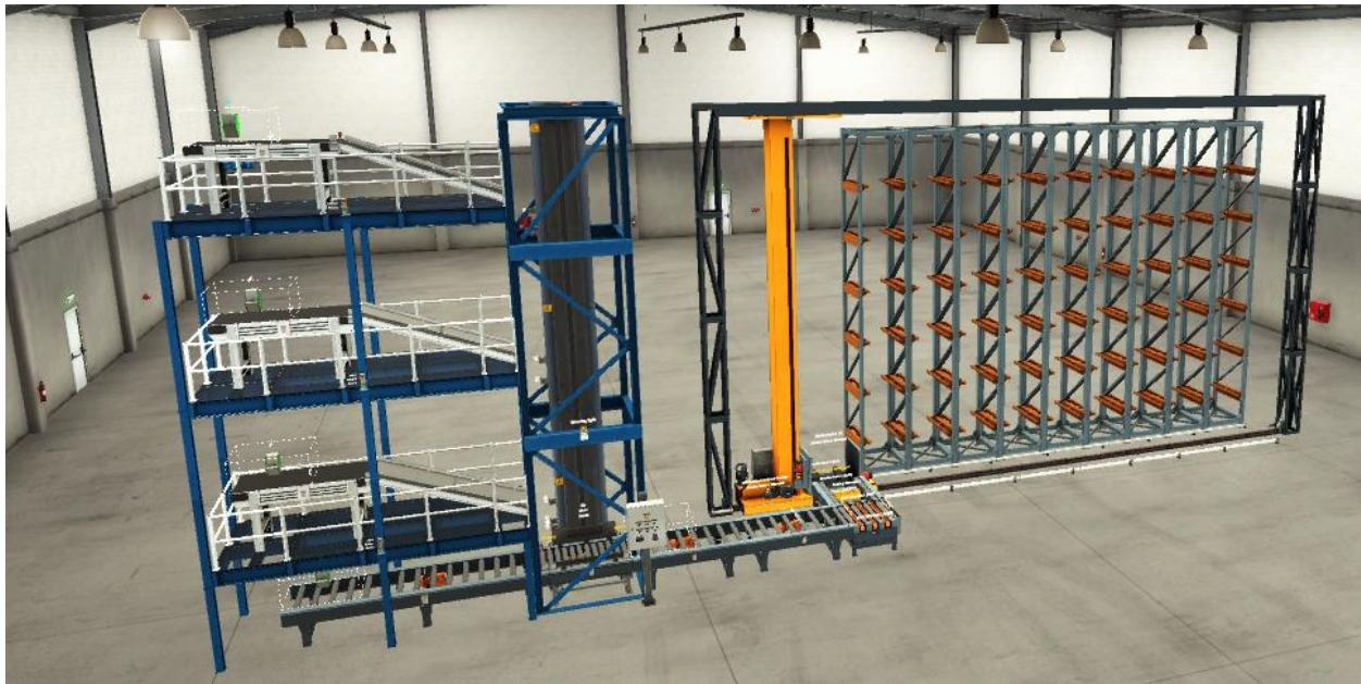
با زدن شستی استارت می باشد یک باکس خالی وارد خط شده و سپس به سمت اسانسور هدایت شود و با قرار گرفتن اسانسور در کابین اسانسور می باشد آسانسور بصورت آهسته به سمت بالا شروع به حرکت نمود و با رسیدن به سنسور high هر طبقه متوقف شده و سپس خط مربوط به طبقه فعال شده و یک قطعه کار داخل باکس قرار گیرد پس از قرار گیری قطعه کار درون باکس ابتدا استانسور بصورت اهسته بسمت بالا شروع به حرکت نموده و با عبور از سنسور high سرعت افزایش پیدا کرده و با رسیدن به سنسور low طبقه بعد ابتدا
