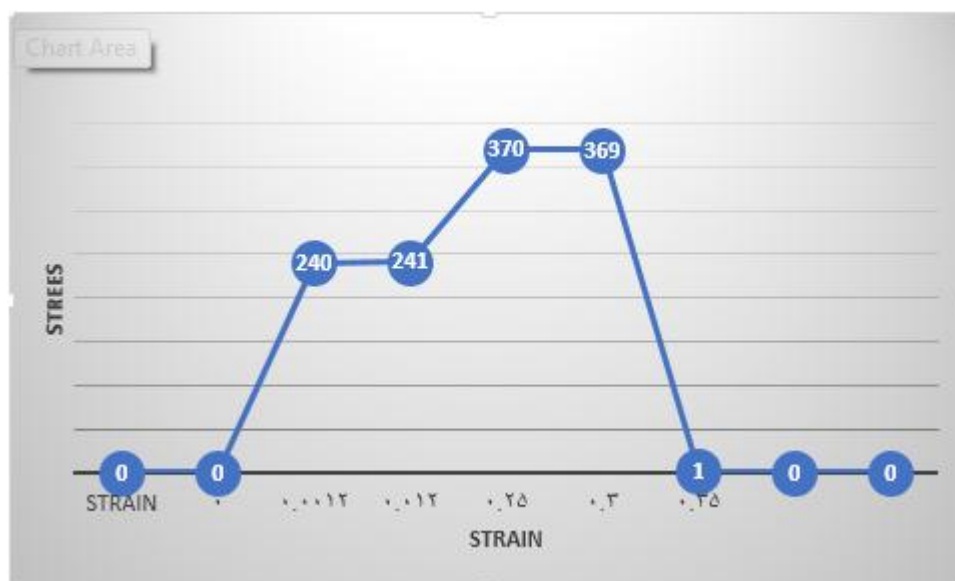
شکل ۴-۹ نمودار تنش - کرنش فولاد
