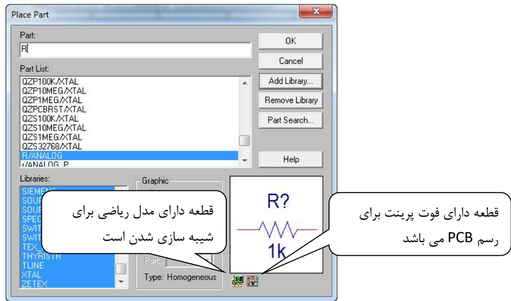
شکل ۳-۸- قطعه ی دارای مدل ریاضی و قطعه ی دارای فوت پرینت
