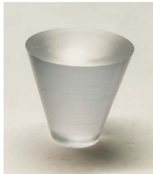
شکل ۳-۱۲- کفشک مخروطی ناقص از جنس پلکسی‌گلاس
