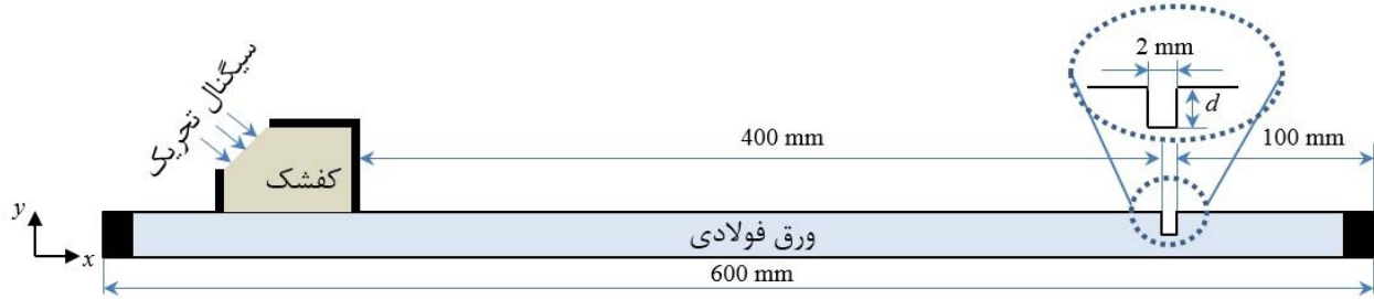
شکل ۴-۴- طرح‌واره‌ی مدل دوبعدی مورد استفاده در شبیه‌سازی اجزای محدود
