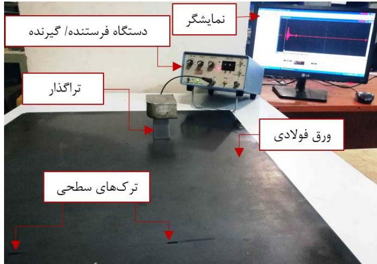
شکل ۳-۶- آزمایش تحریک موج HOMO در ورق
