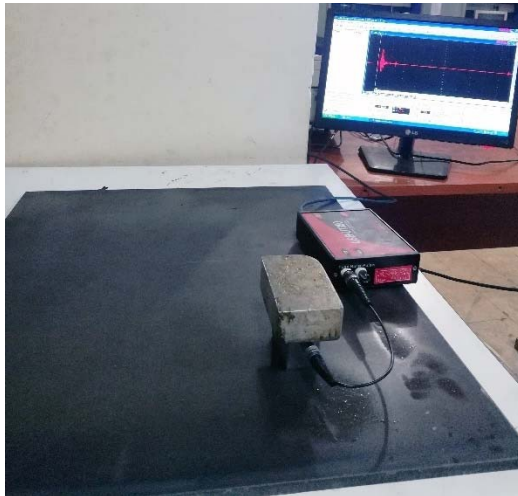
شکل ۵-۶- نمایی از آزمایش تحریک موج HOMC در ورق با استفاده از دستگاه USB-UT350
