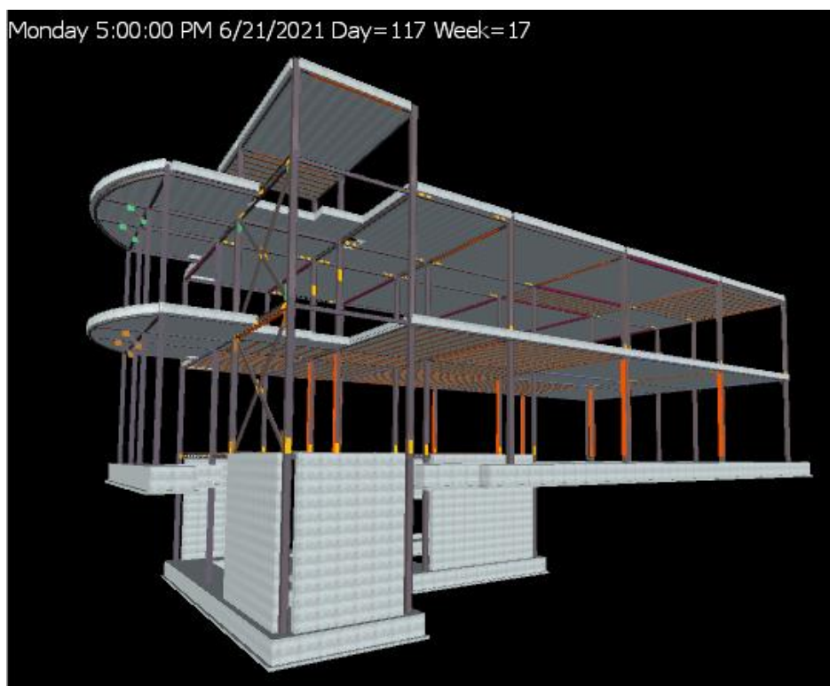
شکل ۴-۱۵- اتمام فرآیند شبیه‌سازی مدل و نمایش زمان اتمام پروژه در Navisworks Manage
