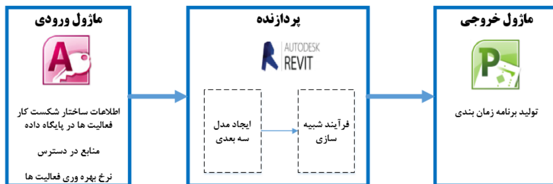
شکل ۲-۱۲- چارچوب استفاده از BIM و شبیه سازی در پژوهش الحسین و همکاران [۵۰]
