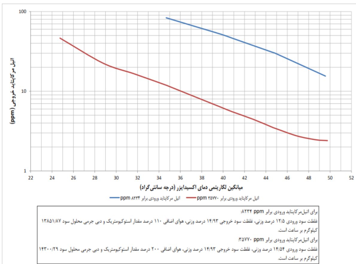
شکل ۴-۱۱- تأثیر دمایی اکسیدایزر بر میزان احیاء سود
