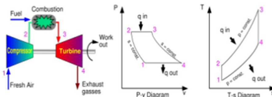
شکل (۹-۱) سیکل توربین گاز
