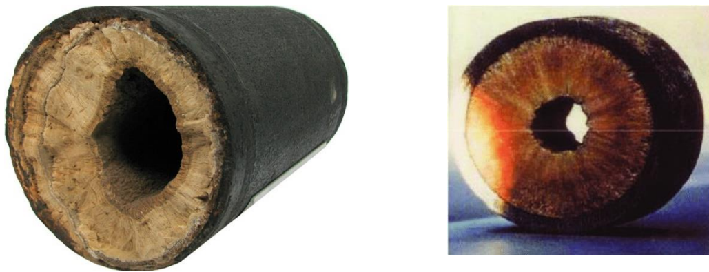
شکل ۱.۱: کاهش قطر مؤثر خط لوله به دلیل رسوب واکس [۲]
