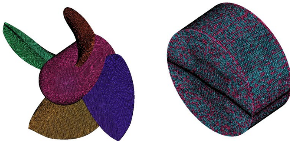
شکل (1-2) شبکه بندی سطح پروانه و سیلندر چرخان
