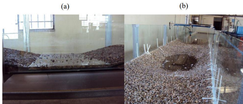
شکل ۲-۸- انواع شکل های بستر برآمده و فرورفته: (a) شکل بستر فرورفته و برآمده دوعبده، (b) شکل بستر فرورفته و برآمده سه بعدی با خط تاج مستقیم
